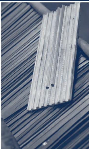
**“Dalla qualità della mina, dipende il piacere della scrittura e la precisione della giustezza della mina nel legno fa la qualità della matita : più la mina è consolidata al legno, meno si spezza.”**
